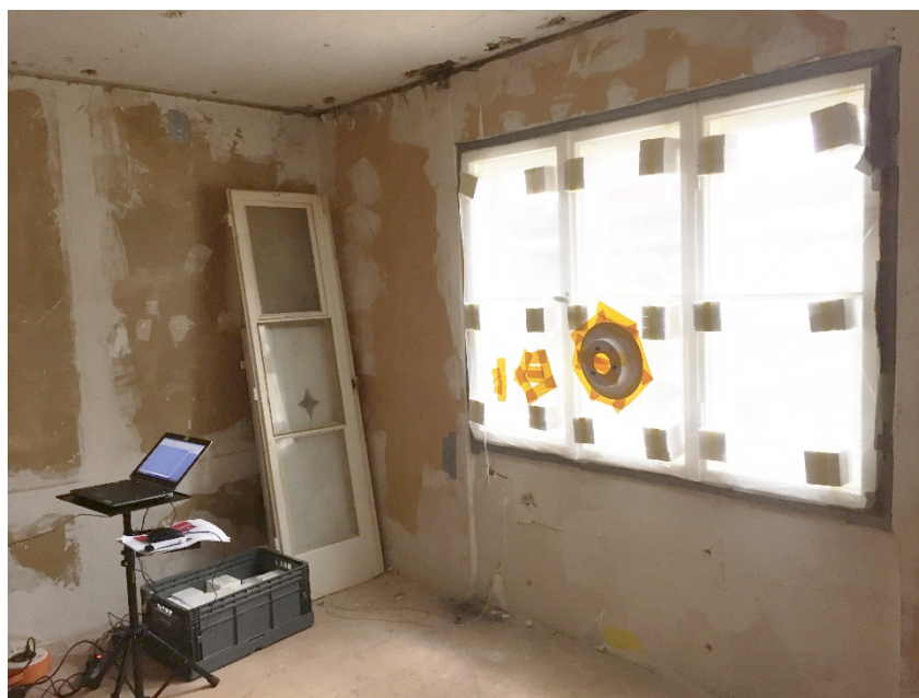
Abbildung 8: Messungen am Kastenfenster Haus Molliné, Stuttgart. (Quelle: HFT Stuttgart / Nansi Palla)
