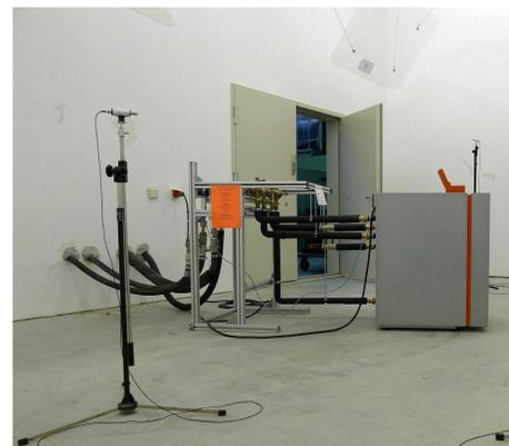
Messung der Geräteschalleistung: Wärmepumpe (links) und Lüftungsgerät (rechts)
