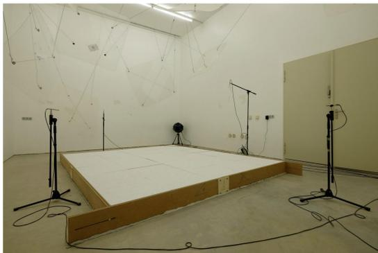
Messung des Schallabsorptionsgrades einer abgehängten Unterdecke
